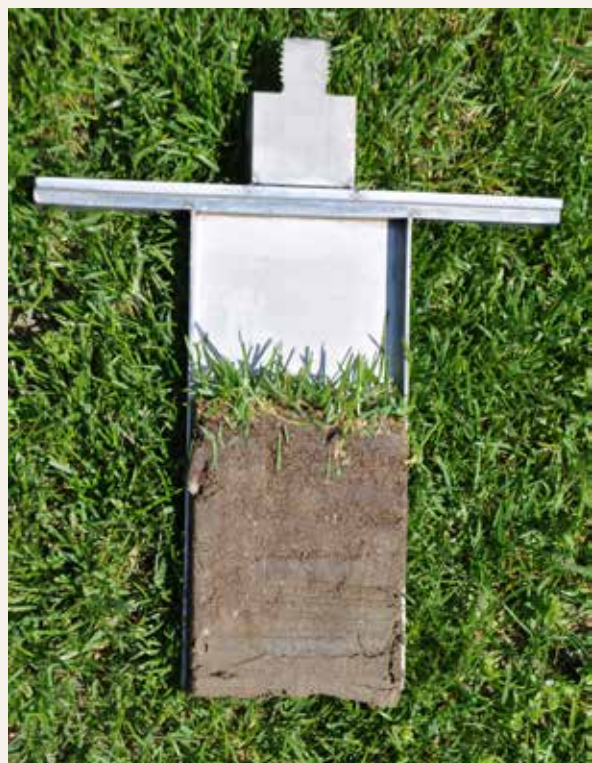
Ein Doppelspaten hilft bei der Begutachtung der Tragschichten und kann zur Entnahme von Bodenproben genutzt werden.
